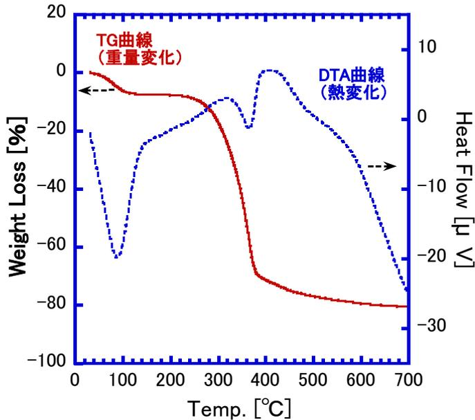
TG 曲線から、加熱温度に対するサンプルの重量変化を確認できます。
